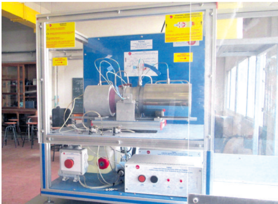
Les ateliers et laboratoires de l'EMI sont dotés d'équipements modernes permettant la formation des ingénieurs dans différents domaines, comme le cas de ce turbo réacteur expérimental pour les études des moteurs d'avions (Ph. NEA)
